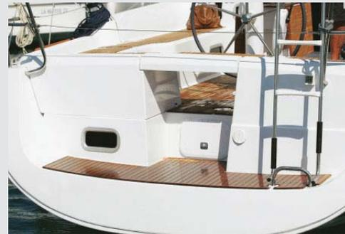
**Coffre à BIB et à gaz à ouverture assistée** • Strut-assisted opening of liferaft and gas locker • *Gavone per zattera e per bombola a gas ad apertura assistita* • Cofre balsa salvavidas abertura asistida por retenedor a gas • *Backskiste für Rettungsinsel und Gasflasche mit Hubzylinde*
